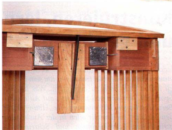
Die Rückseite des Möbels verdeutlicht die Konstruktion: Der Hebelarm aus Stahl ist fest mit dem Rahmen verbunden. Am Ende des Hebelarms ist ein Stift in einer Hammerkopfnut geführt, der den Schubkasten nach vorne drückt und wieder zurückzieht. Die Beschwerung stabilisiert die Schublade im ausgezogenen Zustand.
